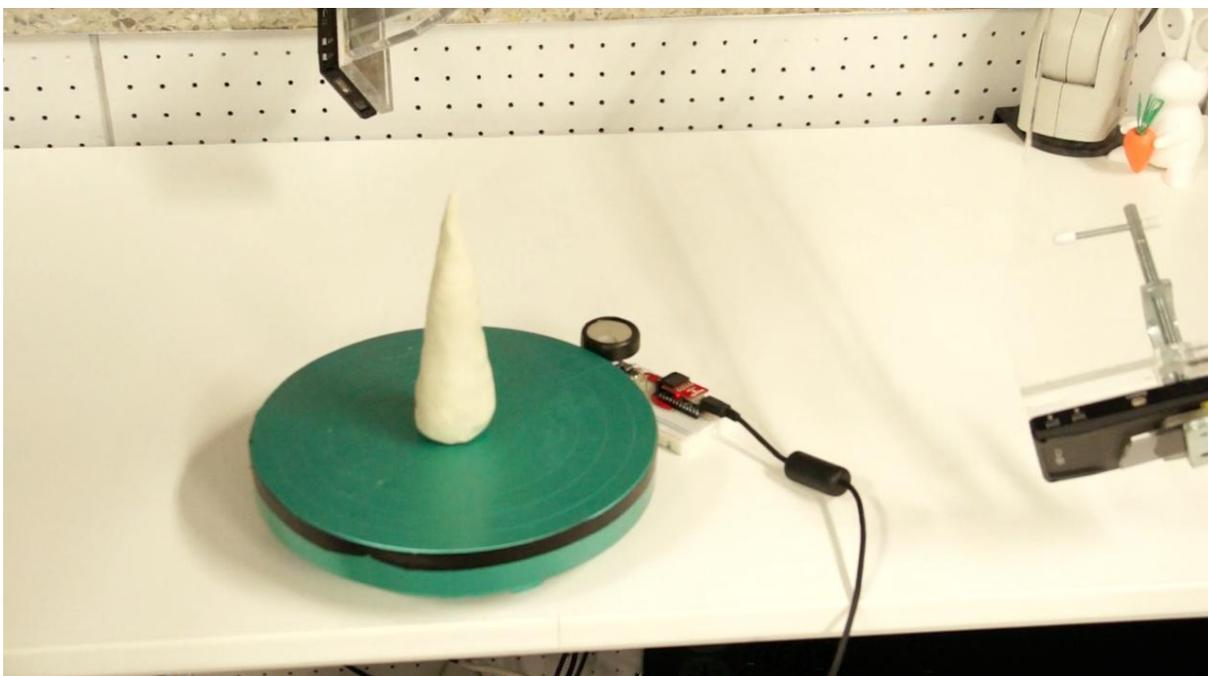
図 15. ろくろの中心に細長い物体を設置しキャリブレーションする様子
