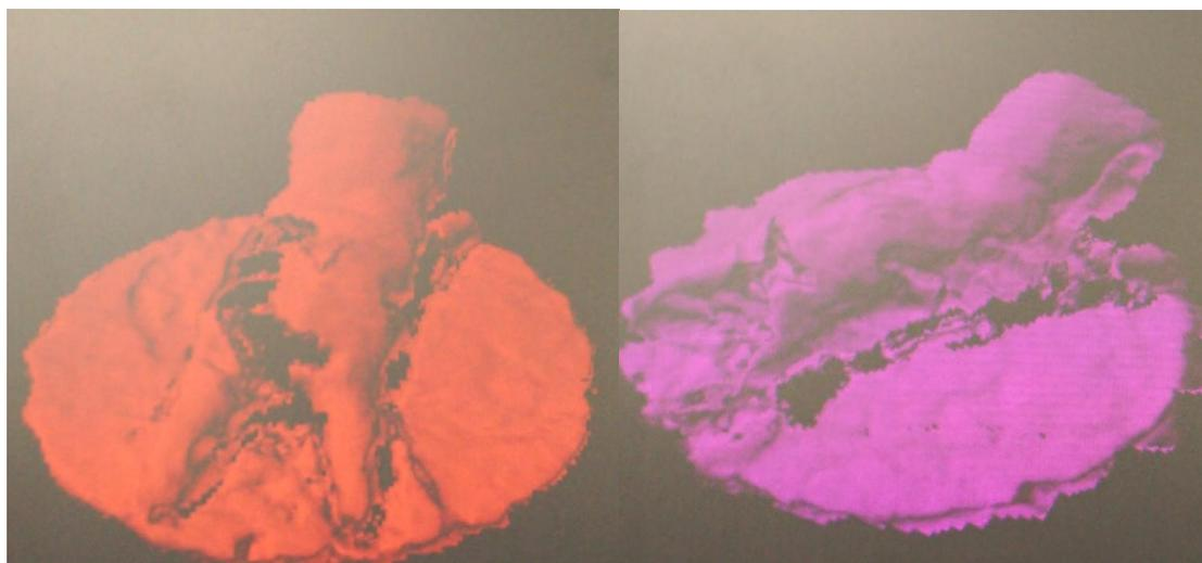
図 16. 回転台の角度変化によって色相が変化する様子(左:赤、右:紫)
