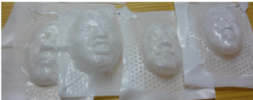
図2:3D スキャナー、3Dプリンタで作成した顔スクリーン
