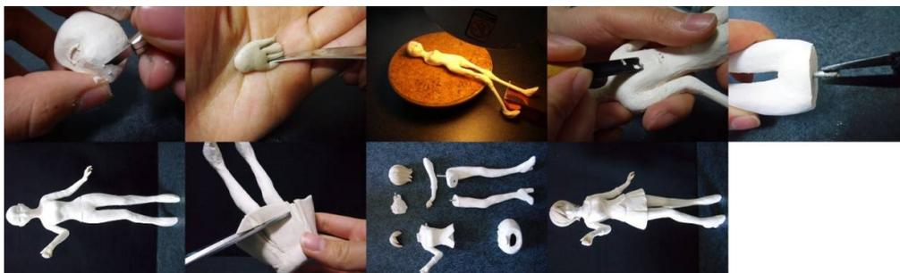
図 1 手作業による原型作成の過程
