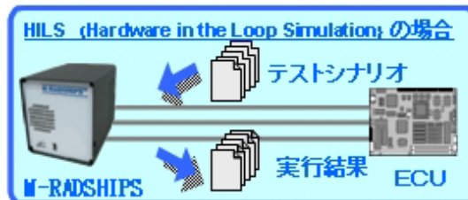
図 8 M-RADSHIPS を利用して HILS を実施する例
