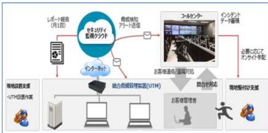
図 16 検知および監視の仕組み（名古屋商工会議所）
