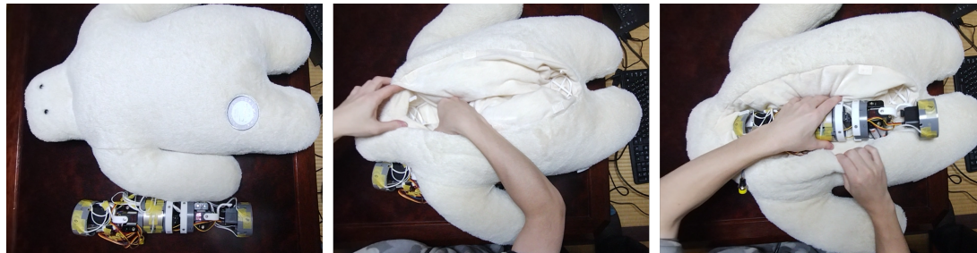
Fig.8: 人型のぬいぐるみロボットの組み立て
