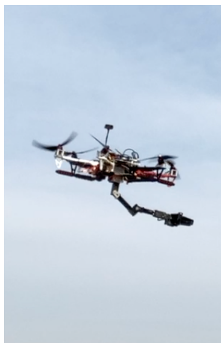
図 7: 非平面ロータ配置かつロボットアームにより飛行中に重心が変化するドローン。
