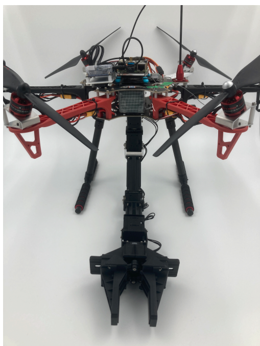
図 7: 非平面ロータ配置かつロボットアームにより飛行中に重心が変化するドローン。
